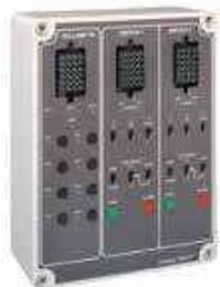
Данный симулятор позволяет тестировать входы и выходы T300 при определенном положении коммутационного оборудования. Комплект поставляется с соединительными кабелями, штекеры которых вставляются вместо выключателя.
