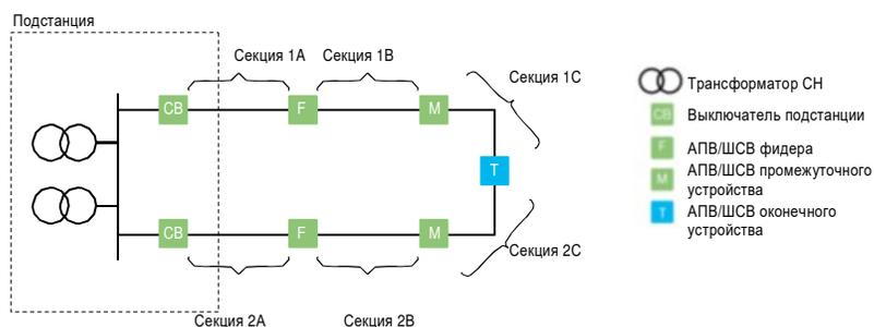
Системы автоматизации контуров состоят из нескольких устройств АПВ/ШСВ, распределенных по контуру в рамках открытой кольцевой топологии. Каждое устройство в этой схеме работает независимо от других, в соответствии со своей предустановленной ролью и заданным набором правил работы.
