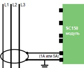
Монтаж С: 1 трансформатор тока нулевой последовательности
