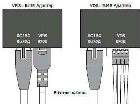
Выход напряжения, разъем RJ45
