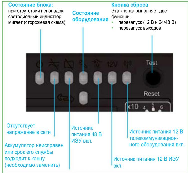
Светодиодные индикаторы состояния: информация о состоянии PS50 отображается светодиодными индикаторами
